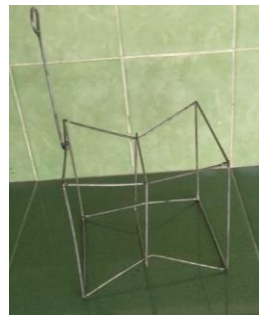
Gambar 1. Kontruksi jaring dengan prinsip plankton net
