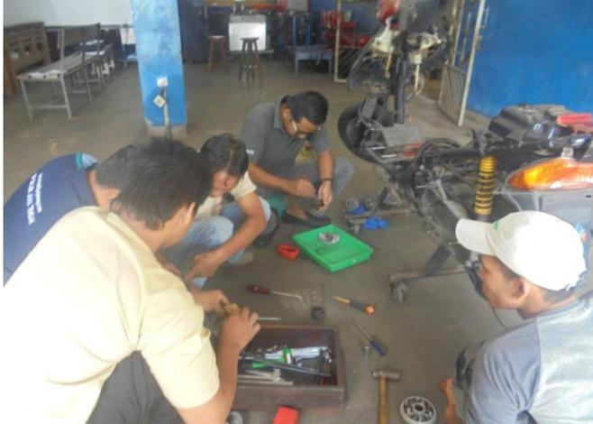
Gambar 5. Peserta melakukan praktik perawatan sistem CVT sepeda motor
