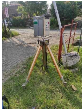
Gambar 3. Posisi gravimeter pada survei gradien vertikal gaya berat mikro antar waktu.
