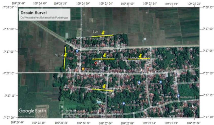
Gambar 2. Desain survei penelitian konfigurasi Schlumberger
