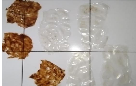
Gambar 1. Hasil pembuatan bioplastik dari limbah kulit singkong dan tepung tapioka.
