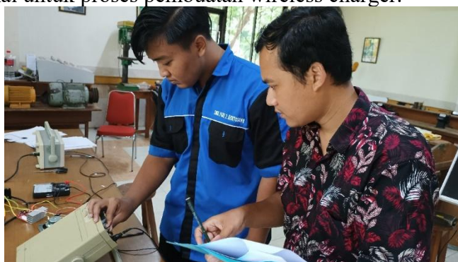
Gambar 9. Pengujian transfer daya secara wireless menggunakan function generator
