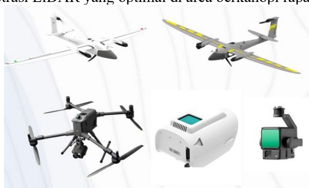
Gambar 2. Wahana akuisisi foto udara dan LiDAR
