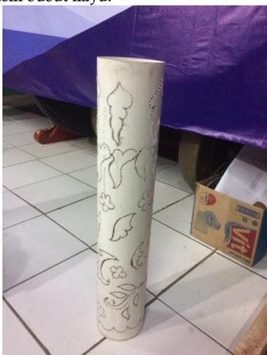
**Gambar 3.** Kerangka Kap Lampu Hias yang Dibuat dengan Mini Grinder
