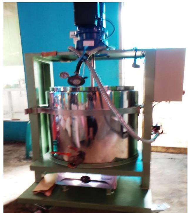
Gambar 3. Alat pasteurisasi otomatis
