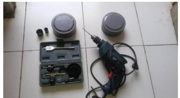
Gambar 4. Alat bor untuk membuat lubang-lubang pada tutup pralon.
