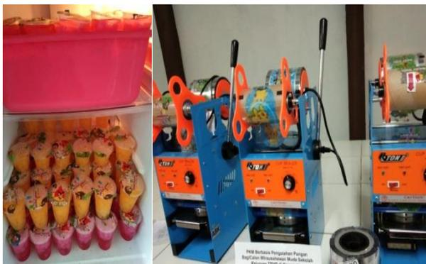
Gambar 7. Alat pengemasan "Cup Sealer"
