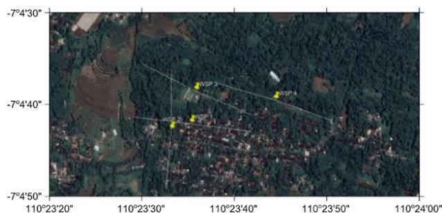
Gambar 4. Lokasi dan Arah Lintasan Pengukuran Geolistrik
