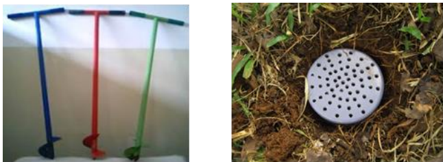
Gambar 2. Bor Biopori (doc. Pribadi) dan Tutup Lubang Biopori (rumahpantura.com)
