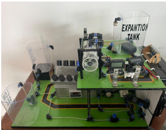
Gambar 1. Hasil Prototype sistem pendingin mesin induk kapal pada praktikum mata kuliah permesinan kapal
